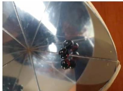
caleidoscopo è minore di 180 gradi. Questi caleidoscopi infatti sono stati costruiti congiungendo l'ipotetico centro di una sfera con tre punti sulla sua superficie. Ogni lato del triangolo sferico è un segmento costruito su una geodetica.
